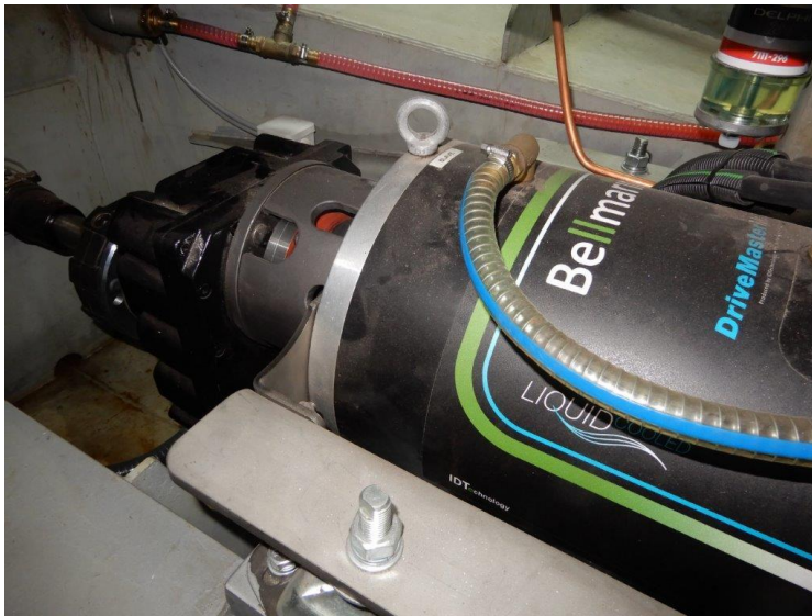
De 2 elektro motoren aan elkaar gekoppeld. Achter de motor zit de reductie kast met schroefas
