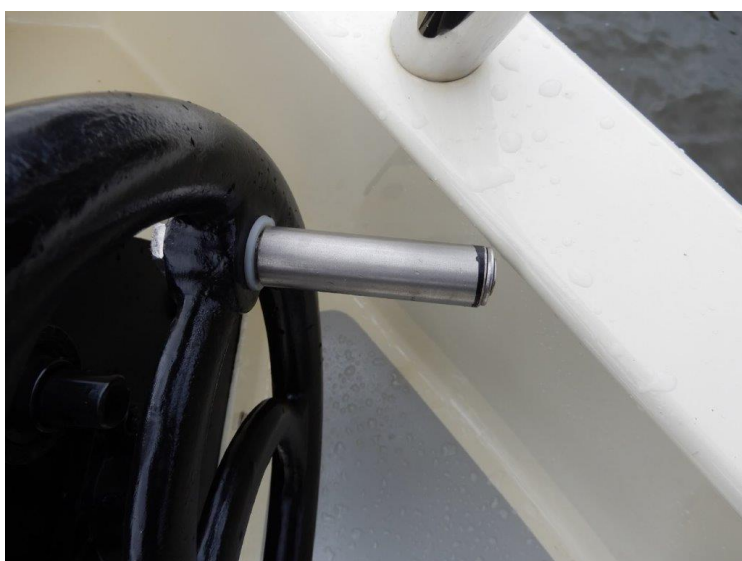
Jaagwiel van de anker winch met ingekorte pen. Je hand loopt klem tegen het potdeksel. Door de energie in het jaagwiel kan je je hand beschadigen
