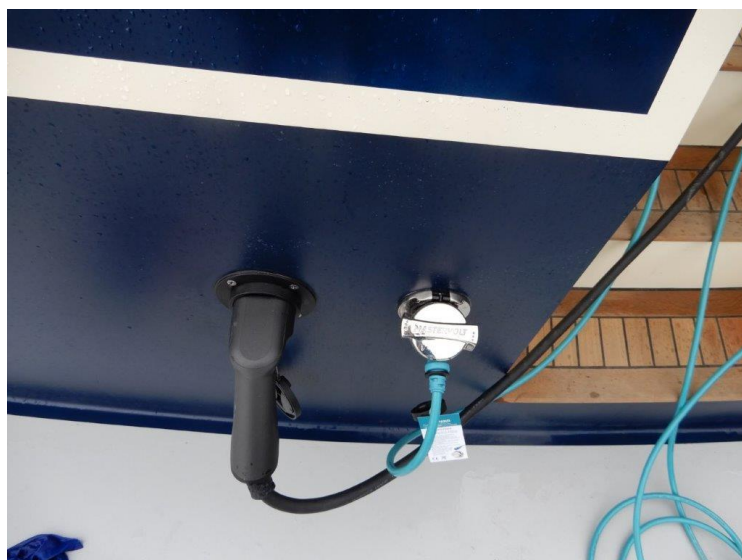
Laad stroom stopcontacten voor het laden via de walstroom
